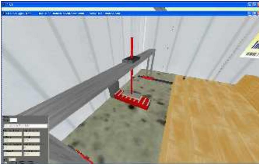
Je nach Lagerkonzept kommt eine 2D oder 3D Visualisierung zum Einsatz. Anlagenzustände lassen sich so leicht erfassen. Auf der Visualisierung lässt sich jeder Stapel mit Plattendaten anzeigen. Einzelne Platten können aus der Datenbank gelöscht oder auch hinzugefügt werden.
